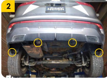
2. Retirar los 4 tornillos de ensamble del bumper ubicados en la zona inferior.
