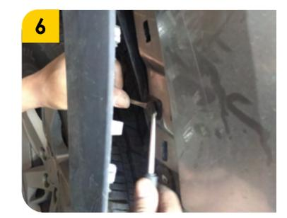
6. Retirar tornillos laterales del bumper ubicados debajo del guardabarros ayudándose con el destornillador y uña.
