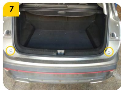
7. Retirar los 2 tornillos de ensamble del bumper ubicados en la zona inferior.
