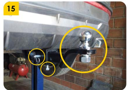
15. Colocar el Porta bola (B), asegurar con pasador (C) y pin de seguridad (D), y apretar firmemente la bola, para evitar vibraciones apretar firmemente el tornillo prisionero (E).
