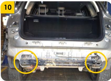
10. Aflojar todos los tornillos de anclaje del alma bumper para proceder a retirarlo.
