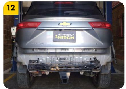
12. Colocar la barra de tiro entre el alma bumper y el vehículo y proceder a fijarlo con los tornillos originales de anclaje.
