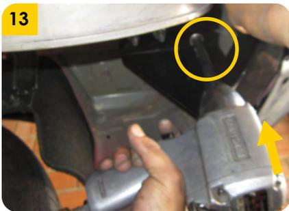
13. Apretar firmemente los puntos de sujeción de ambos lados.
