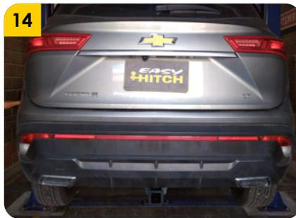
14. Colocar nuevamente el bumper anclando lo con todos sus tornillos y elementos de anclaje.
