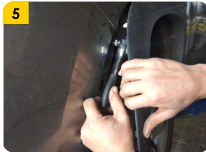
5. Retirar tornillos laterales del bumper ubicados debajo del guardabarros con el ratchet.
