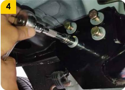
**4.** Colocar el resto de tornillos (G) y arandelas (H) y luego apretar firmemente con un torque de 80 ft/lb. Usar herramienta J, L y N.
