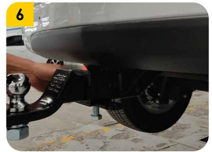
**6.** Ubicar el portabola (B), pasador (D), pin de seguridad (E) y apretar el tornillo prisionero (F) para el tornillo prisionero apretarlo levemente para evitar vibraciones en el portabola (B). Usar herramienta K y Ñ.
