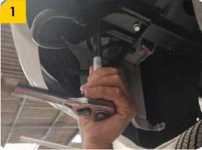
**1.** Retirar de forma permanente el gancho de arrastre ubicado en la parte posterior del vehículo (lado del conductor) para entregarlo al cliente. Usar herramienta K, L, M.
