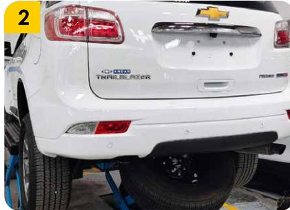
**2.** Aflojar la llanta de repuesto hasta una posición que permita realizar la instalación de una manera mas cómoda siguiendo las indicaciones del manual del vehículo.
