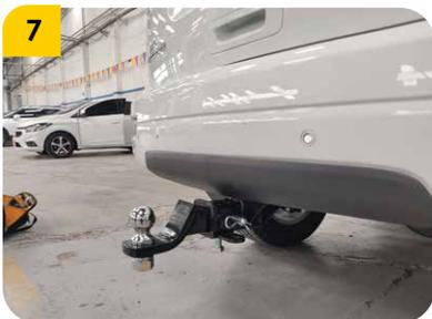
**7.** Finalmente apretar la bola (C) en su posición final con un torque de 250 ft/lb. Usar herramienta J, O y P.
