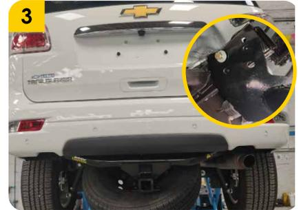
**3.** Acoplar el tiro de arrastre al chasis del vehículo. Posicionar un tornillo (G) y arandela (H) a cada lado del tiro de arrastre.
