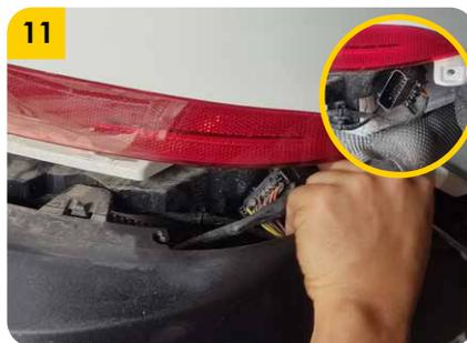
11. Desacoplar la conexión eléctrica que se encuentra en la parte derecha del bumper (lado del copiloto)
