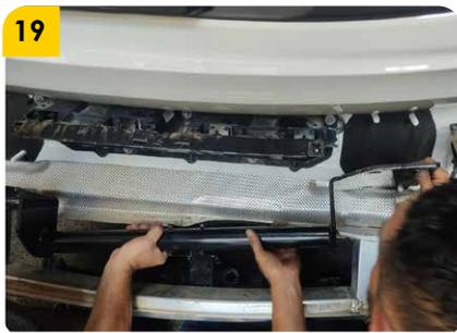
**19.** El alma bumper sigue con puntos de anclaje, se puede pivotar en la parte donde esta anclado e introducir el tiro en la entre el alma bumper y la carrocería. En caso de que no sea posible introducir el tiro de arrastre de esta manera es necesario retirar el alma bumper en su totalidad.
