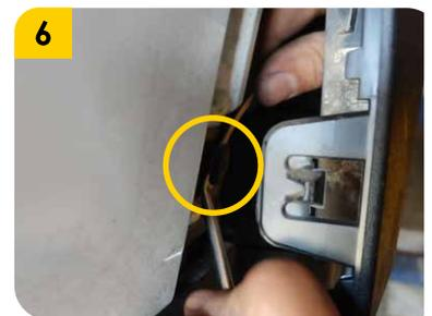
6. Retirar elemento de conexión que se indica en la imagen a cada lado del bumper
