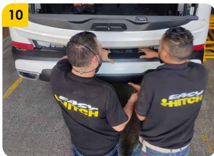
10. Proceder a retirar el bumper con cuidado, no se debe retirar en su totalidad por que tiene conexiones a través de cables.
