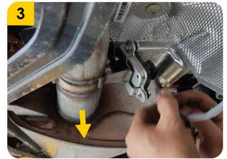
3. Desconectar la línea de cable que aparece visible al retirar las tapas.
