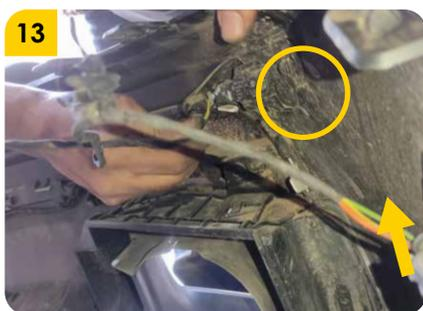
13. Se debe desacoplar los demás puntos de anclaje del cable asociado al lado del conductor.
