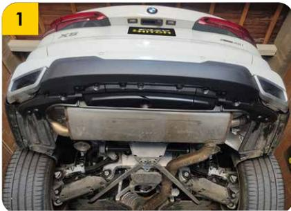
1. Para comenzar con la instalación del tiro es necesario retirar el bumper, retirar los elementos de acople inferiores.
