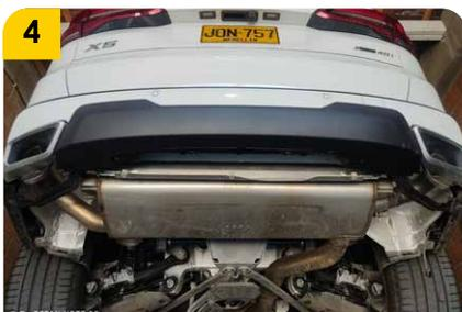
4. Así debe lucir la parte inferior del bumper luego de retirar las partes plásticas inferiores
