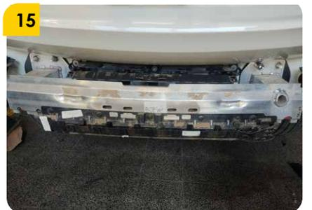
15. Desacoplados todos los sensores y cables asociados a la conexión del bumper con el automóvil se puede proceder a retirar la totalidad del bumper.
