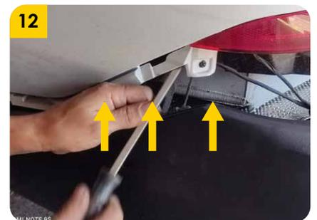
12. Retirar los puntos de acople del cable del lado del conductor para destensionar el cable asociado poco a poco
