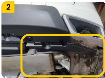
2. Retirar los tornillos de las tapas laterales inferiores de cada lado y tapa central.
