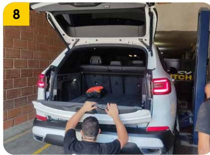
8. Proceder a abrir la puerta del compartimiento trasero de la camioneta, la compuerta inferior abrirla hasta la mitad del recorrido
