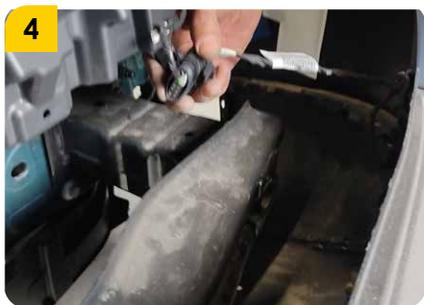
4. Retirar el bumper en su totalidad de la carrocería y realizar la desconexión del ramal de cables asociados.
