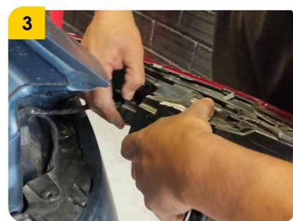
3. Realizar la desconexión del ramal de cables asociado a cada luz trasera.
