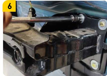
6. Ubicar los tornillos (G) y las arandelas (H) para proceder a realizar la fijación final del tiro de arrastre aplicando un torque de 23 lb/ft.
