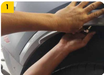
1. Retirar los elementos de sujeción inferiores del bumper y los biseles plásticos de ambos guardabarros con la precaución de evitar que un acople rápido se dañe.
