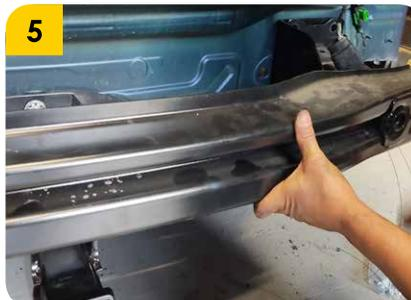
5. Ubicar el tiro de arrastres entre la carrocería del vehículo y el alma bumper metálico.
