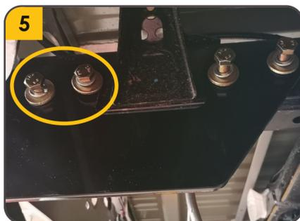
5. Colocar los tornillos (**F.b**) con sus respectivas wasas y arandelas sin apretar, para unir el bumper, el **tiro de arrastre** y el **chasis**.
