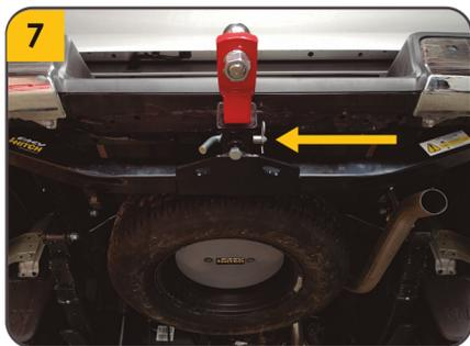
7. Colocar el **Porta bola (B)**, asegurar con pasador (**C**) y pin de seguridad (**D**), y apretar firmemente la bola.
