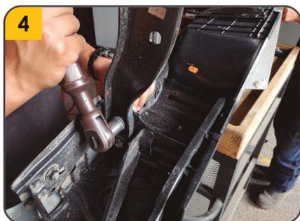
4. En el bumper, soltar los **soportes** que lo unen al **chasis**, para colocar entre ambos, las **platinas espaciadoras (H)**.
