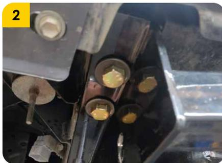
2. Acoplar el tiro de arrastre al chasis del vehículo y posicionar todas las arandelas y tornillos sin apretar.
