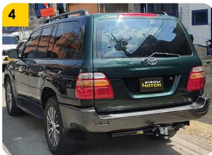
4. Instalar el portabola (B), bola (C) pasador (D), pin de seguridad (E) y el tornillo prisionero (F), para la bola aplicar un torque de 250ft/lb y para el tornillo prisionero un torque leve que evite vibraciones en el portabola (B).
