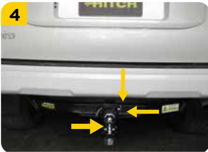
4. Colocar el Porta bola (B), asegurar con pasador (C) y pin de seguridad (D), y apretar firmemente la bola.
