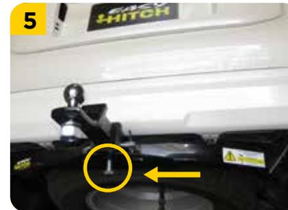
5. Para evitar vibraciones en el Porta bola (B) fijar el tornillo (prisionero E) a la tuerca ubicada en la parte inferior del tiro de arrastre.
