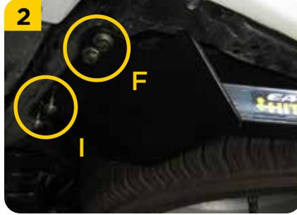
2. Colocar los tornillos (F) y (I) sin apretar, con sus respectivas arandelas (G) y (J), y guasas (H) y (K), para unir el **tiro de arrastre** con el **chasis**.
