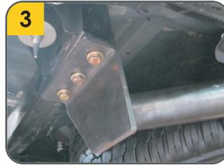
**3.** Fijar los extremos del tiro de arrastre al chasis con las arandelas **(G)**, guasas **(H)** y Tornillos **(F)**, en dicho orden.
