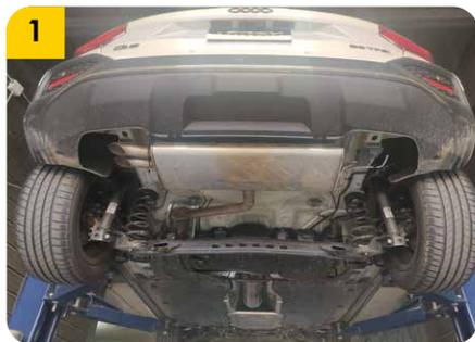
1. Retirar elementos de sujeción del bumper plástico.
