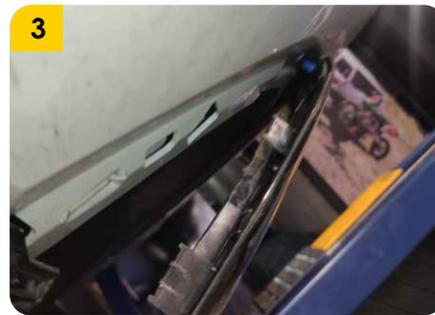
3. Retirar los biselados plásticos de ambos guardabarros con la precaución de evitar que un acople rápido se dañe.
