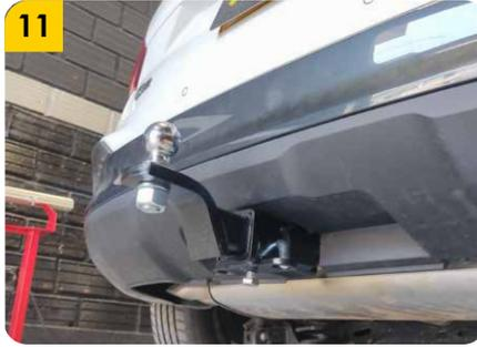
11. Instalar el portabola (B), bola (C) pasador (D), pin de seguridad (E) y el tornillo prisionero (F).
