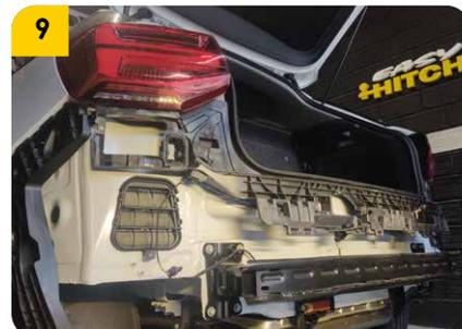
9. Ubicar el tiro de arrastre entre la carrocería y el alma bumper para fijar el tiro de arrastre con los tornillos (G) y arandelas (H)
