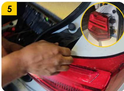
5. Retirar la tapa plástica de cada luz trasera y los tornillos de sujeción que aparecen.
