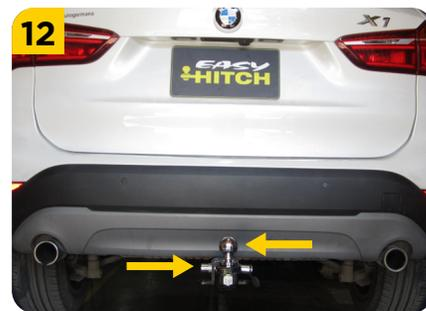
12. Colocar el Porta bola (**B**), asegurar con pasador (**C**) y pin de seguridad (**D**), y apretar firmemente la bola.
