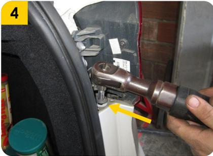
4. Soltar el **tornillo** señalado, que sujeta el **bumper**.
