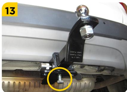
13. Para evitar vibraciones en el Porta bola (**B**) fijar el tornillo (**prisionero E**) a la tuerca ubicada en la parte inferior del tiro de arrastre.
