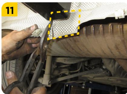
11. Cortar un rectángulo (preferiblemente con unas tijeras para metal) el **aislante de calor** para permitir que este no interfiera con el receptor del **tiro de arrastre**.
