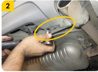
2. Retirar los **tornillos** que sujetan el **bumper** en la parte inferior del vehículo.
