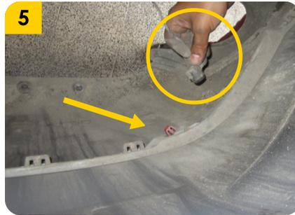
5. Antes de retirar por completo el **bumper**, soltar cuidadosamente las **conexiones eléctricas, sensores y/o cámara trasera**.
