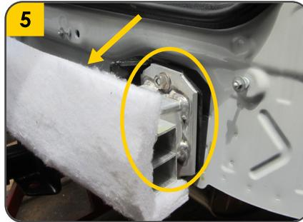
5. Soltar las 4 tuercas (**G**) que sujetan el **alma bumper** al **chasis** y retirarlo. Después acoplar el **tiro de arrastre** con el **alma bumper**, el **chasis** y fijar firmemente las 4 tuercas (**G**).
