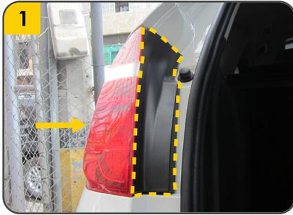
1. Abrir la maleta del vehículo y luego retirar la **cubierta de caucho** a las luces del stop, para acceder a las conexiones.
