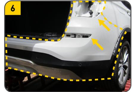
6. Colocar nuevamente el **bumper**, el **stop** y la **cinta reflectante** con sus respectivos tornillos
