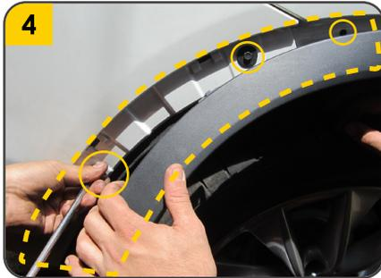
4. Retirar los **tornillos** y **pines** que sujetan el **bumper** en la parte inferior y en los **guardabarros**. Luego remover el **bumper**.
