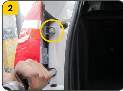
2. Remover las **2 tuercas** de las luces del stop y después desconectar el **sistema eléctrico** para remover las luces. Repetir en el otro lado
