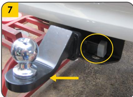
7. Colocar el Porta bola (**B**) (o cualquier accesorio de carga y/o arrastre que desee), asegurar con pasador (**C**) y pin de seguridad (**D**), y apretar firmemente la bola.
