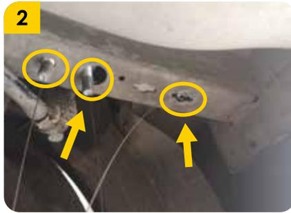
2. Realizar la técnica de pesca, para colocar los 3 tornillos de carriaje (F) dentro del chasis con sus respectivas platinas (G) y pescas (J).
