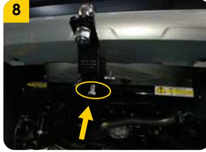
8. Para evitar vibraciones en el Portabola (B) fijar el tornillo prisionero (E) a la tuerca ubicada en la parte inferior del tiro de arrastre.
