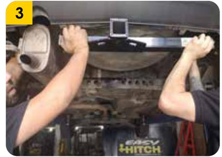
3. Acoplar el tiro de arrastre al chasis pasando las pescas (J) por las perforaciones de las platinas de anclaje del tiro de arrastre
