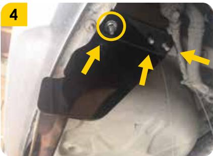
4. retirar las pescas (J) de los tornillos teniendo cuidado de que no se introduzcan los tornillos (F) dentro del chasis y luego colocar las 6 tuercas (H) sin apretar
