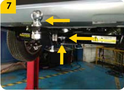
7. Colocar el Portabola (B), asegurarlo con el pasador (C) y pin de seguridad (D), y apretar firmemente la bola.
