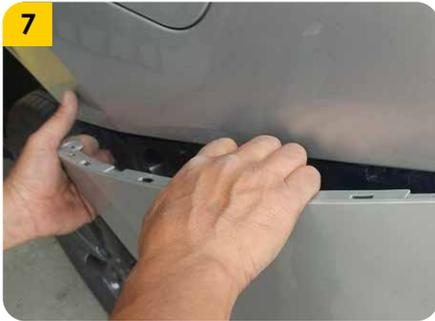
7. Desacoplar los puntos de sujeción del bumper ubicados en los laterales del vehículo.
