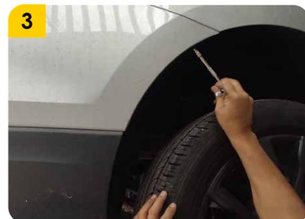
3. Remover los tornillos de sujeción ubicados en la zona inferior del guardabarros con el bumper.
