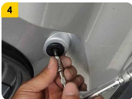
4. Proceder a abrir la puerta de la maleta y retirar los tornillos de sujeción centrales del bumper.
