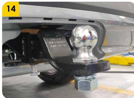
14. Instalar el portabola (B), bola (C) pasador (D), pin de seguridad (E) y el tornillo prisionero (F), para la bola aplicar un torque de 250ft/lb y para el tornillo prisionero un torque leve que evite vibraciones en el portabola (B).
