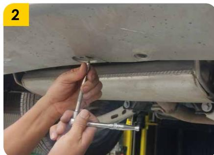
2. Remover los tornillos de sujeción ubicados en la zona inferior del bumper.
