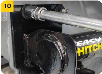
10. Ubicar las tuercas (L) originales que trae el vehículo y remitirse al manual del vehículo para aplicar el torque especificado.
