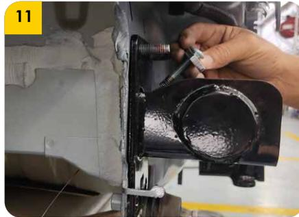
11. Realizar el proceso de técnica de pesca en el interior de la carrocería usando los tornillos (G), platinas (H) y pescas (K)
