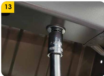
13. Ubicar las arandelas y tuercas para proceder a realizar el respectivo apriete aplicando un torque de 20ft -lb.
