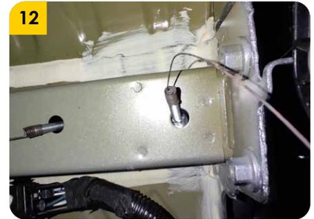
12. Retirar las pescas con la precaución de evitar que se queden en la parte interior de la carrocería.
