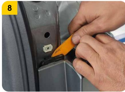
8. Desacoplar los puntos de sujeción centrales del bumper, en lo posible usar herramientas plásticas para evitar dañar sus puntos de sujeción.
