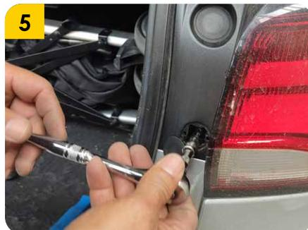
5. Retirar los tornillos de sujeción de las luces traseras y proceder a desacoplarlas de sus pines de sujeción con el vehículo.
