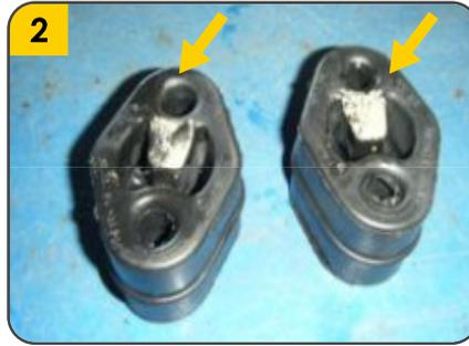
2. Remover los 2 **soportes de caucho** sujetos al **exosto**.
