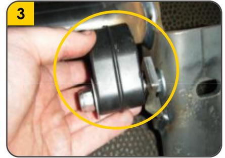
3. Sujetar los soportes de caucho a la **platina (G)** con el **tonillo (M)** y sus respectivas **tuercas (N)** y **arandelas (J)**
