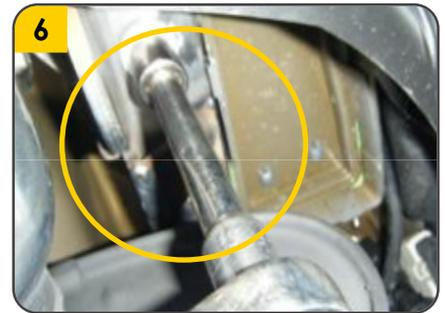
6. Asegurar el **tiro de arrastre** con los **tornillos (K)** y sus respectivas **arandelas (G)** y **guasas (L)**, luego remover la **pesca** y colocar la **tuerca (H)** en el **tornillo restante (K)**.
