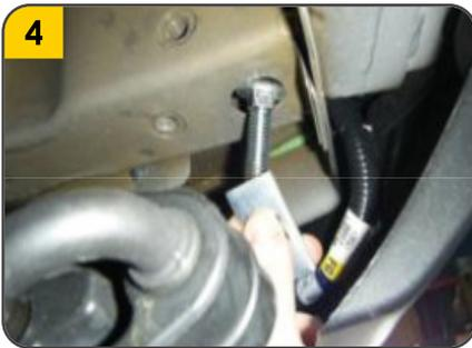
4. Usar la **técnica de pesca inversa** y colocar el **tornillo (F)** con su **pesca** y **platina** en la primera perforación del **chasis** (lado del pasajero)
