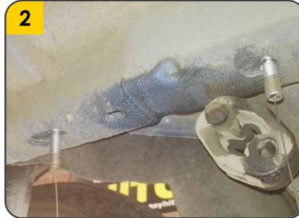
2. Tomando como referencia el tiro de arrastre, ubicar cada una de las perforaciones de anclaje y utilizando la técnica de pesca colocar los 4 tornillos de carriaje (F) dentro del chasis con sus respectivas platinas y pescas.
