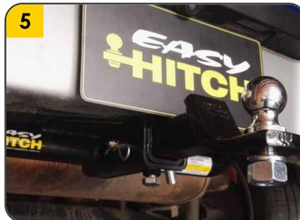
5. Instalar Porta bola aplicando un torque de 250 ft/lbs y asegurar con pasador y pin. Apretar firmemente la bola en el Porta bola.
