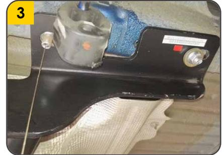
3. Sin remover las pescas, acoplar el tiro de arrastre en el chasis, luego fijarlo con las tuercas (H), aplicar un torque de 25 ft/lbs remover cada pesca a medida que se coloca cada tuerca.
