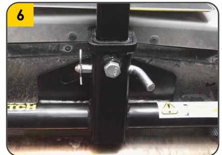
6. Para evitar vibraciones en el Porta bola fijar el tornillo (E) a la tuerca ubicada en la parte inferior del tiro de arrastre.
