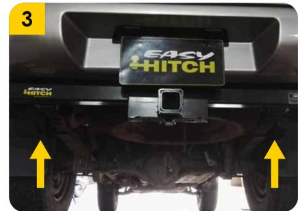
3. Acoplar el tiro de arrastre en el chasis y colocar los tornillos (F) con sus respectivas arandelas (G) a ambos lados sin apretar.
