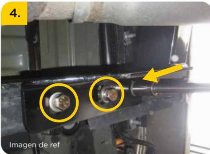
4. Apretar firmemente los tornillos (I) en ambos lados con un torque de 80 ft/lbs.
