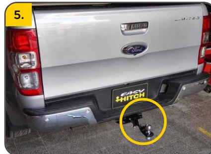
5. Colocar el Porta bola (B), asegurar con pasador (C) y pin de seguridad (D), y apretar la bola (B) con un torque de 250 ft/lb. Para evitar vibraciones en el Porta bola (B) apretar el tornillo (E) con un torque leve para evitar vibraciones.
