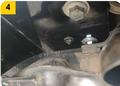
4. Acoplar el tiro de arrastre en el chasis con la tornillería original (aplicar un torque de 146 ft/lbs) y a los tornillos de carriage ubicar su arandela (J) y tuerca (K) para aplicar un torque de 55 ft/lbs.
