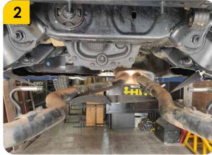
2. De ser necesario acoplar una línea de soporte de lado a lado del vehículo para evitar el descenso total de los mofles.
