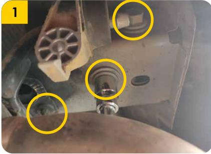
1. Retirar temporalmente la tornillería original del vehículo ubicada en la zona posterior del chasis incluyendo los ganchos de soporte del mofle.
