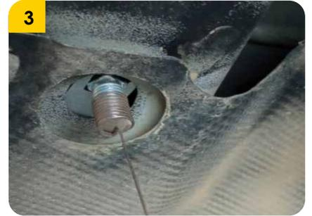
3. Realizar el proceso de pesca en los agujeros originales del chasis a con los tornillos de carriage (H), platina (I) y pesca (L)
