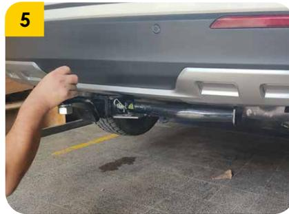
7. Ubicar el portabola (B), pasador (C), pin de seguridad (D) y apretar el tornillo prisionero (E) con un torque leve para evitar vibraciones.
