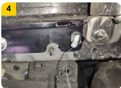
4. Con el tiro de arrastre acoplado proceder a reensamblar los acoples del mofle.
