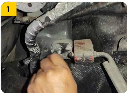
1. Retirar los acoples del mofle y permitir que descienda, de ser necesario utilizar una línea y/o cuerda de soporte de lado a lado del vehículo para que el mofle no descienda excesivamente.
