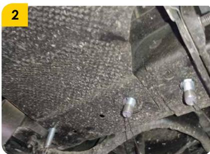
2. Realizar la técnica de pesca, los tornillos F y sus accesorios se ubican en la parte trasera del vehículo y los tornillos K y accesorios se ubican en la parte delantera del vehículo.
