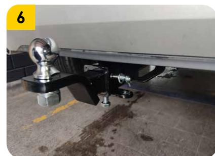
6. Ubicar el kit B (Portabola y bola) y apretar la bola con un torque de 250 ft/lbs, finalizar ubicando el pasador (C), pin de seguridad (D) y apretar el tornillo prisionero (J) con un torque leve para evitar vibraciones.
