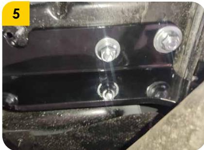
6. Proceder a realizar el apriete de los tornillos de anclaje con torque de 80 ft/lbs para los tornillos M12 (F) y un torque de 50ft/lbs para los tornillos M10 (K).
