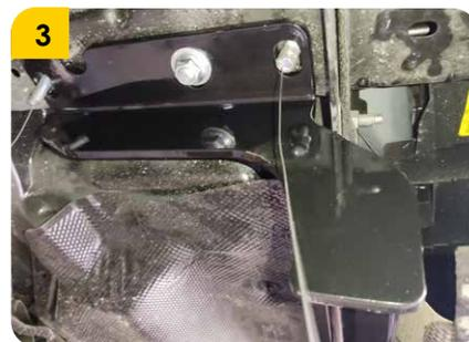
3. Proceder a instalar el tiro de arrastre, ingresar las pescas por los agujeros de anclaje del tiro de arrastre para guiar su anclaje con la carrocería del vehículo y apretar levemente un tornillo a cada lado.
