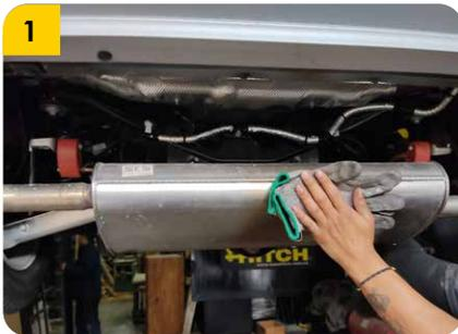
1. Retirar los acoples del mofle y permitir que descienda, de ser necesario utilizar una línea y/o cuerda de soporte de lado a lado el vehículo para que el mofle no descienda excesivamente.
