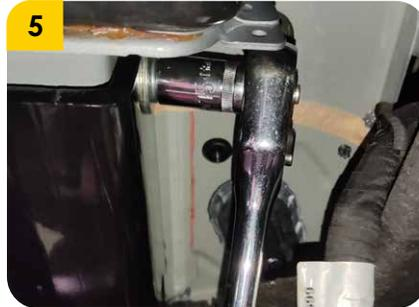
5. Proceder a realizar el apriete de los tornillos de anclaje (E) con un torque de 50 ft/lbs y posteriormente proceder a ubicar los guardapolvos.
