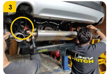
3. Luego de realizar el proceso de pesca de la tornillería proceder a instalar el tiro de arrastre, ingresar las pescas por los agujeros de anclaje del tiro de arrastre.
