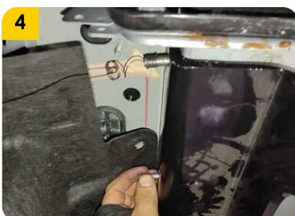
4. Con el tiro de arrastre posicionado y la tornillería visible proceder a retirar las pescas evitando que la tornillería ingrese al interior del chasis.
