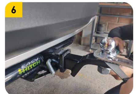
6. Ubicar kit B (Portabola y bola) y aplicar un torque de 250 ft/lbs a la bola, finalizar ubicando el pasador (C), pin de seguridad (D) y apretar el tornillo prisionero (J) con un torque leve para evitar vibraciones.
