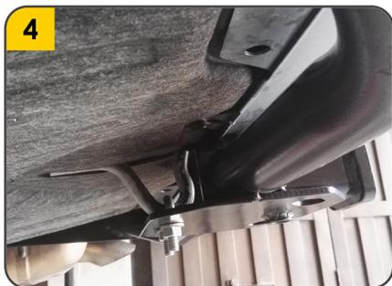
4. Usando el tornillo en U (K) sujetar el tiro de arrastre desde detrás del receptor al gancho ubicado en el centro del vehículo. Colocar las tuercas (L) y apretar firmemente.
