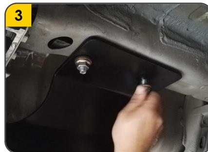
3. Sin remover las pescas, acoplar el tiro de arrastre en el chasis, luego fijarlo firmemente con las tuercas (H), remover cada pesca a medida que se coloca cada tuerca.
