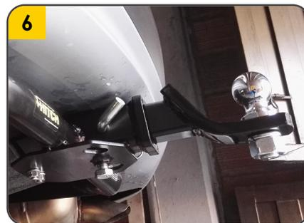
6. Instalar Porta bola y asegurar con pasador y pin. Para evitar vibraciones en el Porta bola fijar el tornillo (E) a la tuerca ubicada en la parte inferior del tiro de arrastre.
