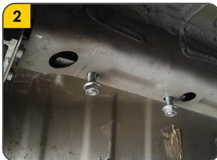
2. Tomando como referencia el tiro de arrastre, ubicar cada una de las perforaciones de anclaje y utilizar la técnica de pesca para colocar los 4 tornillos de carriaje (F) dentro del chasis con sus respectivas platinas y pescas.
