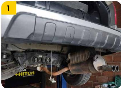
1. Durante el tiempo de instalación retirar los cauchos del mofle y la llanta de repuesto.
