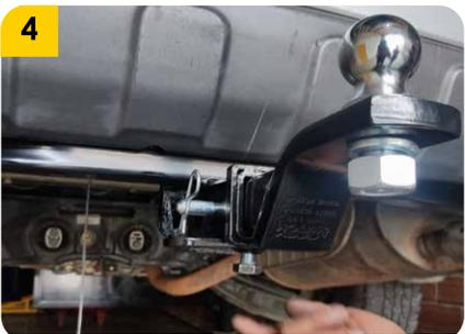
4. Ubicar el portabola (B), bola (C), pasador (D), pin de seguridad (E) y apretar la bola (B) y el tornillo prisionero (F) con un torque leve para evitar vibraciones.
