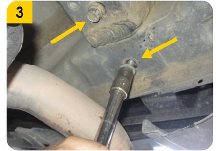
3. Retirar los tornillos que vienen anclados al chasis (es posible que el vehículo no tenga anclados los tornillos).
