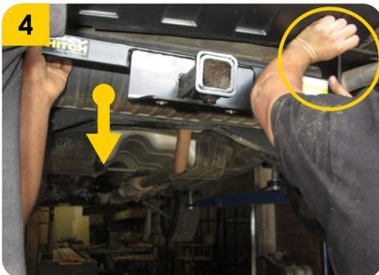
4. Halar firmemente el **exosto** hacia abajo para introducir los anclajes del **tiro de arrastre** y poder acoplarlo al **chasis** del vehículo.
