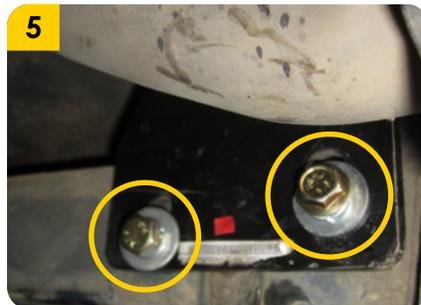
5. Colocar los tornillos (F) sin apretar con sus respectivas arandelas (G) y guasas (H), para unir el **tiro de arrastre** con el **chasis**.
