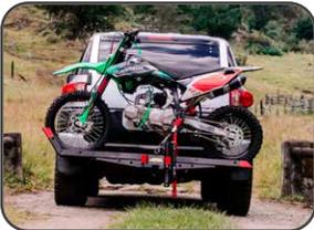
**Portamotos:** Útil para el transporte de motocicletas evitando el uso de remolque.
