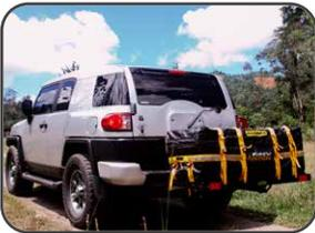
**Portaequipajes:** Útil para cuando el espacio de carga del vehículo es insuficiente o para casos en que el equipaje puede deteriorar el interior del vehículo.
