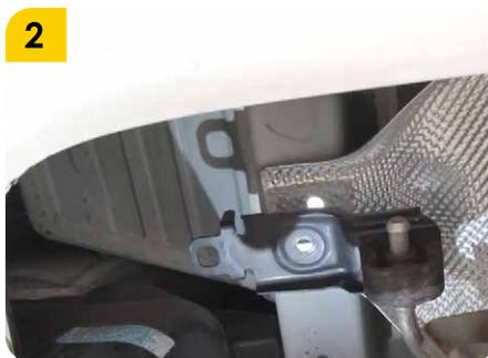
2. Desacoplar los soportes del mofle y retirar el protector de calor.
