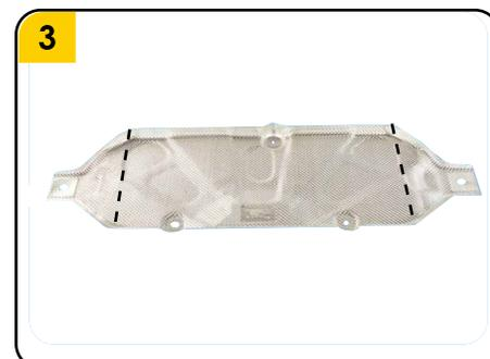
3. Realizar el corte señalado al protector de calor y proceder a instalarlo nuevamente.
