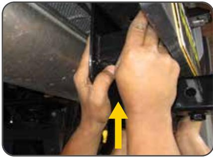
1. Acoplar el **tiro de arrastre** en el **chasis** (alinear las 4 perforaciones del **chasis** con las 4 perforaciones del **tiro de arrastre**).
