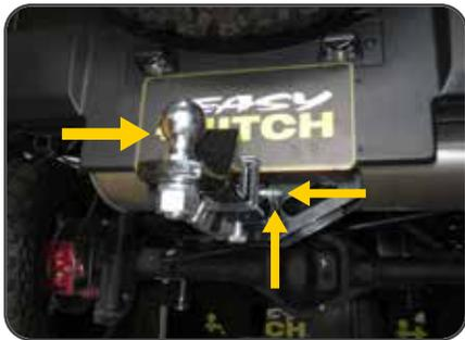
4. Colocar el **Porta bola (B)** (o cualquier accesorio de carga y/o arrastre que desee), asegurar con pasador **(C)** y pin de seguridad **(D)**, y apretar firmemente la bola.
