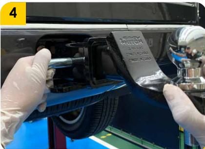
4. Ubicar el portabola (B), pasador (D) y pin de seguridad (E), proceder a apretar la bola (C).
