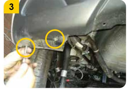
3. Retirar los **tornillos** que sujetan el **bumper** en la parte inferior del vehículo.
