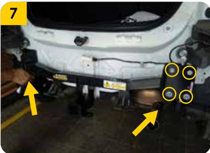
7. Colocar las **tuercas (F)** y apretar firmemente las **8 tuercas** que sujetan el **alma bumper**, el **tiro de arrastre** y el **chasis**.
