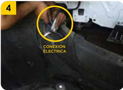
4. Antes de retirar por completo el **bumper**, soltar cuidadosamente las **conexiones** eléctricas, **sensores** y/o **camara trasera**.
