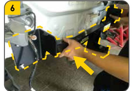
6. Soltar las 6 **tuercas (F)** que sujetan el **alma bumper** al **chasis** y retirarlo para acoplar el **tiro de arrastre** al **chasis**.
