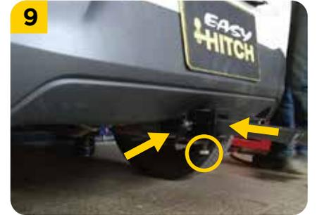
9. Colocar el **Porta bola (B)** y apretarlo, asegurar con **pasador (C)** y **pin de seguridad (D)**. Para evitar fijar el **tornillo (prisionero E)** en la parte inferior del **tiro**.
