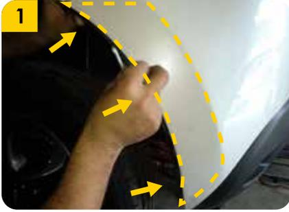
1. Retirar los **tornillos** y **pines** que sujetan el **bumper** en los **guardabarros**.
