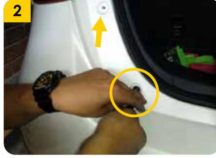
2. Retirar los **tornillos** señalados, que sujeta el **bumper**.
