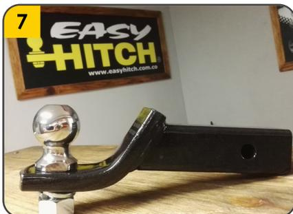
7. Instalar Porta bola y asegurar con pasador y pin. Apretar firmemente la bola en el Porta bola
