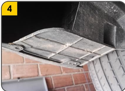
4. Retirar los tornillos y pines que sujetan el bumper al vehículo, ubicados en la parte inferior del mismo y en el guardabarros. Por ultimo remover el bumper.
