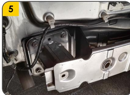
5. Soltar las 8 tuercas (G) que sujetan el alma bumper al chasis y retirarlo. Luego acoplar el tiro de arrastre y el alma bumper nuevamente y fijar firmemente las 8 tuercas (G).
