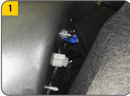
1. Abrir la maleta del vehículo y detrás de las luces de stop, abrir el tapete para acceder a sus conexiones.
