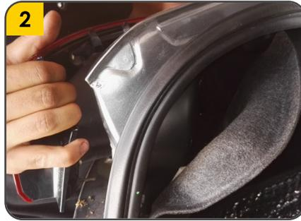
2. Remover las 3 Tuercas que unes las luces al vehículo y luego desconectar la conexión eléctrica para remover las luces. Repetir en ambos lados.
