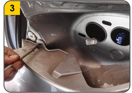
3. Remover el tornillo ubicado detrás de las luces de stop, que une el bumper al chasis.
