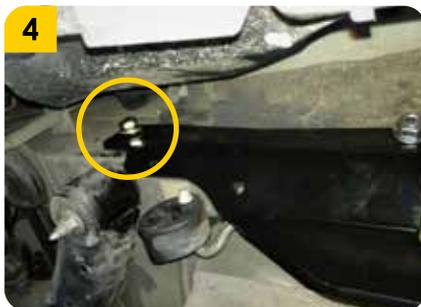
4. Colocar los tornillos (**J**) a ambos lados sin apretar, con sus respectivas arandelas (**K**) y guasas (**L**), para unir el **tiro de arrastre** con el **chasis**.
