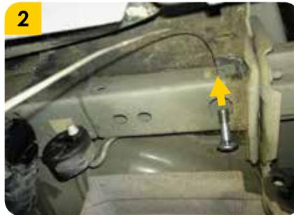
2. Realizar la técnica de **pesca**, colocar los **tornillos de carriaje (F)** dentro del **chasis** con sus respectivas **platinas (G)** y **pescas (I)**.
