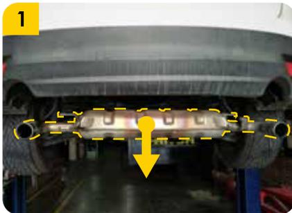
1. Bajar el **exosto** retirando el **enganche** para una mayor comodidad y facilidad en la instalación del **tiro de arrastre**.
