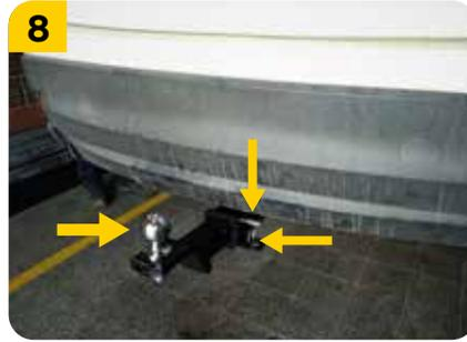
8. Colocar el Porta bola (B), asegurar con pasador (C) y pin de seguridad (D), y apretar firmemente la bola.
