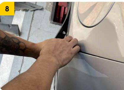
8. Proceder a retirar el bumper plástico de sus puntos de sujeción.
