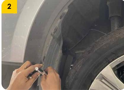
2. Remover los elementos de sujeción de los guardapolvos plásticos y proceder a retirarlos.
