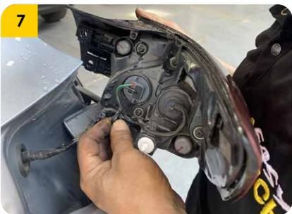
7. Retirar las luces traseras de sus pines de sujeción y proceder a realizar la desconexión del ramal de cables asociados.
