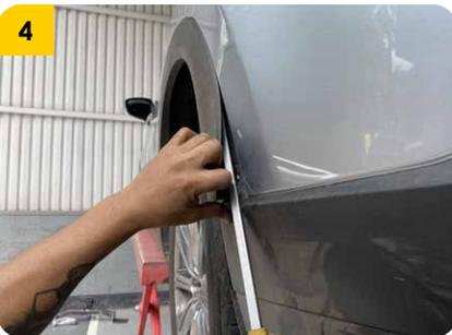
4. Desacoplar las molduras laterales plásticas de sus acoples rápidos con precaución.
