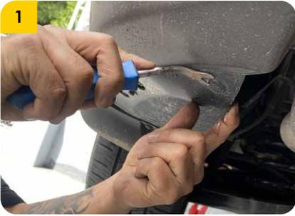
1. Remover cubiertas inferiores de cada lado del guardabarros de ambas ruedas traseras.
