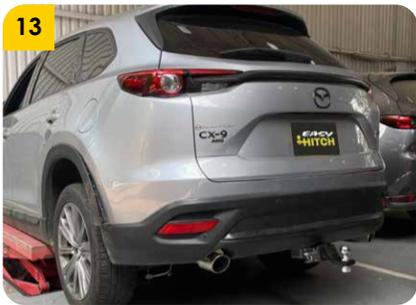
13. Colocar el porta bola (B), asegurar con pasador (D) y pin de seguridad (E), apretar la bola aplicando un torque de 250ft/lb y apretar levemente el tornillo (F) para evitar vibraciones.
