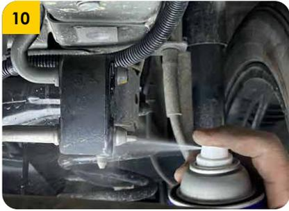
10. Desacoplar el tanque del exhosto al soltarlo de sus cauchos de sujeción.
