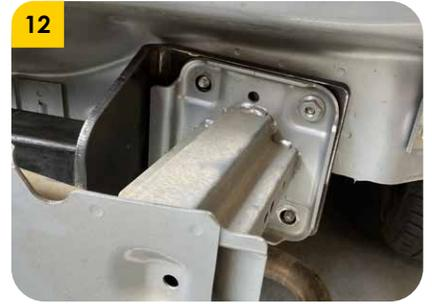
12. Ubicar el alma bumper y realizar el apriete con la tornillería original (G), remitirse al manual del usuario para revisar el torque que se debe aplicar.
