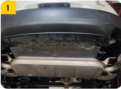
1. Retirar el sistema de escape de sus 4 cauchos de sujeción, adicional se debe reposicionar el deflector de calor para prevenir interferencias con el tiro de arrastre, de lo contrario puede generar ruidos indeseados.
