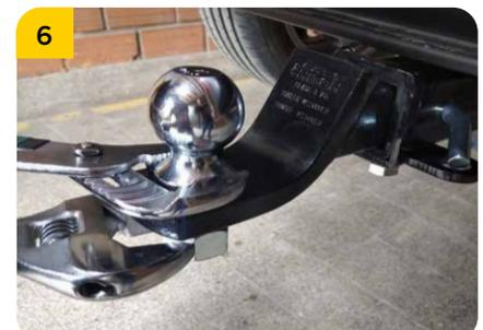
6. Colocar el porta bola (B), asegurar con pasador (D) y pin de seguridad (E), apretar la bola aplicando un torque de 250ft/lb y apretar levemente el tornillo (E) para evitar vibraciones.
