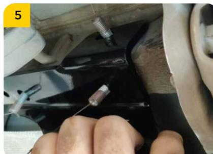
5. Retirar las pescas (K) con la precaución de evitar que la tornillería ingrese al interior del vehículo y proceder a realizar el apriete aplicando un torque de 20ft/lb.
