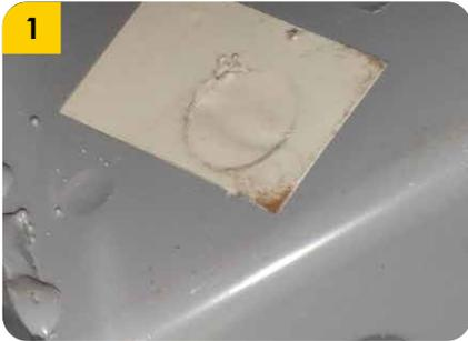
1. Retirar las calcas de las perforaciones de anclaje de la barra de tiro de arrastre.
