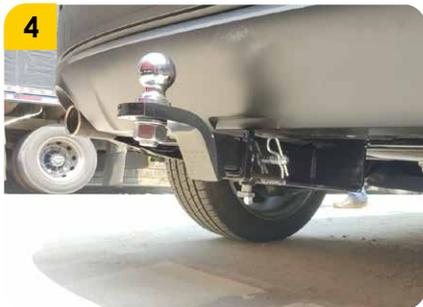
4. Ubicar el portabola (B), pasador (D) y pin de seguridad (E), proceder a apretar la bola (C) con un torque de 250ft/lb, ubicar el tornillo prisionero (F) y apretarlo para evitar vibraciones en el portabola.
