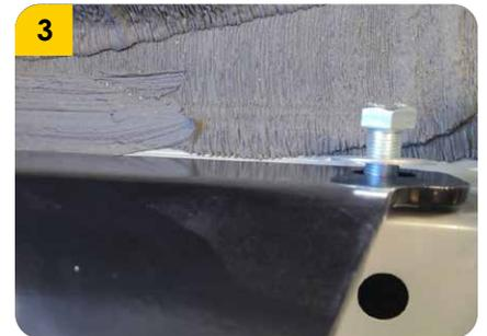
3. Posicionar la tornillería con los tornillos (G), arandelas de presión (H) y las arandelas (I) y realizar el apriete de la tornillería con un torque de 86ft/lb.
