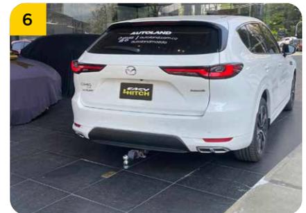
6. Colocar el porta bola (B), asegurar con pasador (D) y pin de seguridad (E), apretar la bola (F) aplicando un torque de 250ft/lb y apretar levemente el tornillo (F) para evitar vibraciones.
