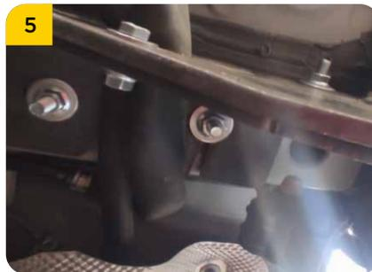
5. Proceder a realizar el apriete de la tornillería de carriaje (G) aplicando un torque de 70 ft/lb y a los tornillos hexagonales (L) aplicar un torque de 86 ft/lb.
