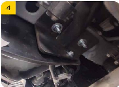
4. Ubicar el tiro de arrastre con las platinas de sujeción restantes con la guía de las pescas (K) para proceder a ubicar las arandelas (I) y tuercas (J) sin apretar para posteriormente ubicar los tornillos (L) con dos arandelas (M) para cada tornillo y su respectiva tuerca de seguridad (N).
