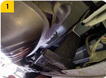
1. Retirar la tapa plástica inferior de sujeción del bumper junto con las torres de sujeción asociadas.
