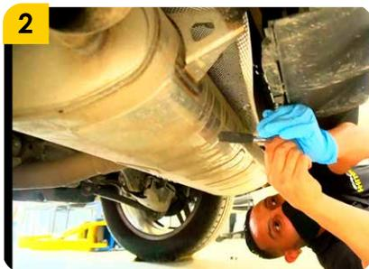
2. Retirar los puntos de fijación inferior del bumper.
