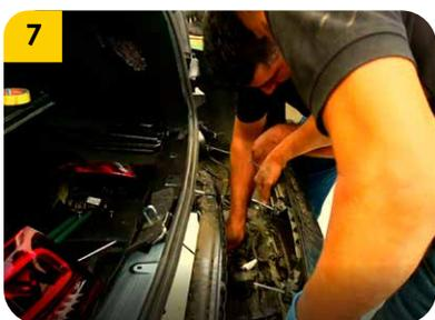
7. Proceder a retirar el alma bumper plástico y en el proceso desacoplar las conexiones eléctricas asociadas para retirar en su totalidad el alma bumper.
