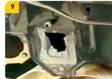
9. Limpiar la zona de apoyo del alma bumper y aplicar un sellante (no incluido en el kit de instalación) en la cara del tiro de arrastre que apoyará en la carrocería y en la superficie de la platina de anclaje del lado del pasajero en donde apoyara el alma bumper.
