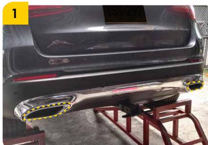
1. Retirar los adornos de mofle removiendo sus elementos de fijación internos.
