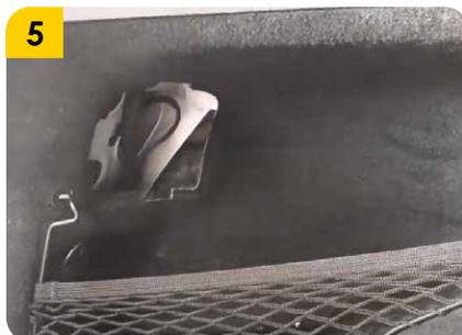
5. Abrir la abertura lateral al interior del portaequipaje y proceder a retirar los elementos de sujeción de las luces traseras.
