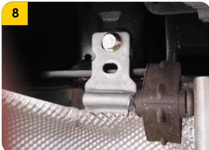
8. Desacoplar los puntos de sujeción del mofle.
