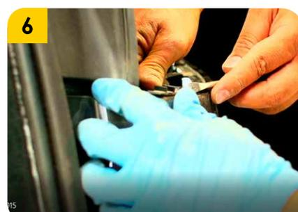
6. Despinar con cuidado los puntos de sujeción del bumper que aparecen al retirar las luces traseras.
