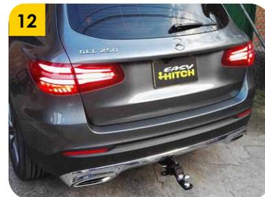
**12.** Ubicar la porta bola (B), pasador (D) y pin de seguridad (E), proceder a apretar la bola (C), ubicar el tornillo prisionero (F) y apretarlo para evitar vibraciones en la porta bola.
