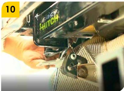
**10.** Proceder a posicionar el tiro de arrastre en su posición junto con el alma bumper para proceder a apretar la tornillería original.
