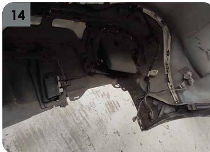
14. Mientras una persona sostiene el bumper la otra persona debe proceder a realizar la desconexión final de los sensores relacionados al bumper para que se pueda retirar en su totalidad el bumper.
