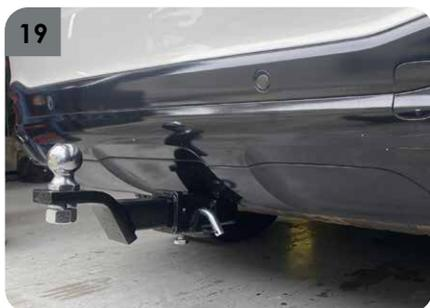
19. Ubicar el portabola (**B**), pasador (**D**) y pin de seguridad (**E**), proceder a apretar la bola (**C**) con un torque de 250ft/lb, ubicar el tornillo prisionero (**F**) y apretarlo para evitar vibraciones en el portabola.
