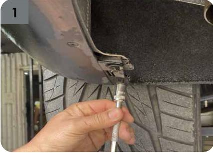
1. Retirar los pines y tornillos de sujeción inferior del bumper y de los guardabarros.
