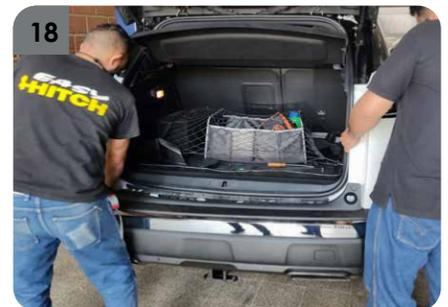
18. Reinstalar el bumper plástico y componentes retirados para la instalación del tiro de arrastre, remitirse al manual del fabricante para comprobar el par de apriete de los componentes que lo requieran.
