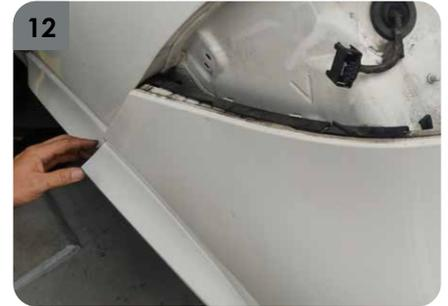
12. Despinar zonas laterales del bumper cercanas al guardabarros con la precaución de evitar que un acople rápido se dañe.
