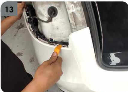
13. Despinar con cuidado los puntos de sujeción del bumper plástico que aparecen al retirar las luces traseras.
