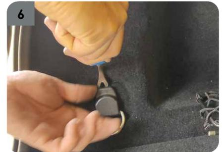
6. Desacoplar la pieza plástica asociada al gancho del portaequipaje del lado del conductor del vehículo y proceder a retirar el tornillo asociado.
