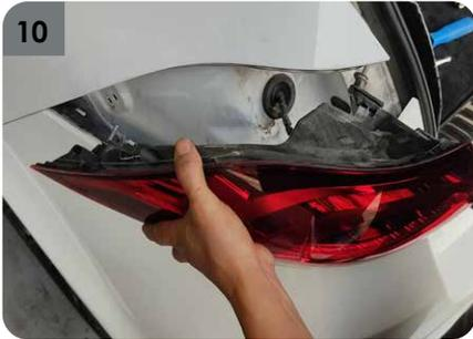
10. Desmontar las luces traseras y realizar la desconexión del ramal de cables asociado a cada luz trasera.
