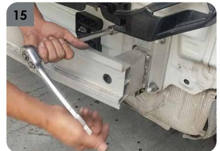
15. Retirar la **tornillería original del vehículo** que acopla el alma bumper y proceder a limpiar los residuos de sellante, es necesario aplicar un sellante (no incluido en el kit) en la zona donde apoyara el tiro de arrastre en la carrocería.
