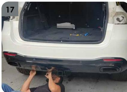
17. Posicionar el bumper plástico de forma que permita realizar la marcación el corte necesario para reinstalar el bumper plástico.
