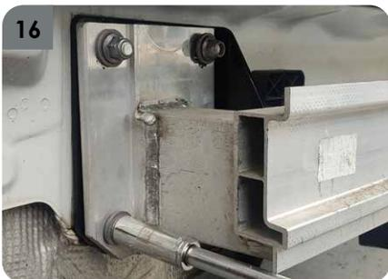
16. Ubicar el tiro de arrastre junto con el alma bumper para proceder a realizar su apriete usando nuevamente la **tornillería original del vehículo**, se debe remitirse al manual del fabricante para comprobar el par de apriete.
