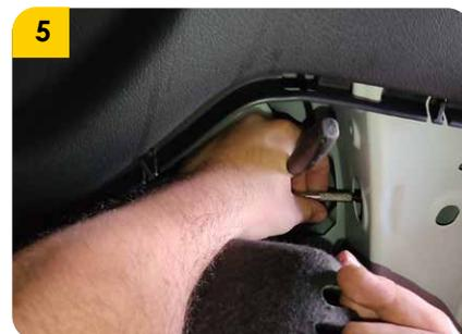
**5.** Retirar tapas laterales ubicadas en el interior del portaequipaje para proceder a retirar el elemento de acople de los stops.
