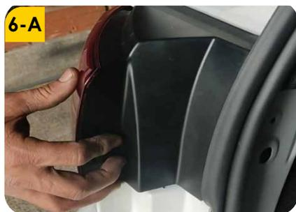
**6-A.** Proceder a retirar los stops, se debe retirar con mucha precaución para evitar que se quiebre algún pin o costilla de acople rápido.
