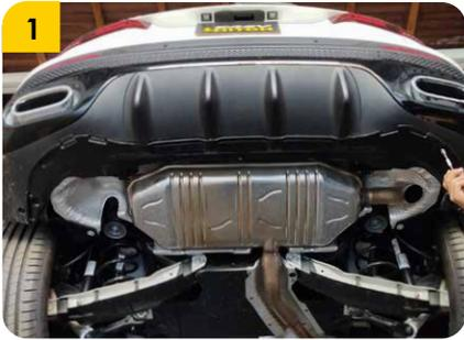
**1.** Retirar todos los elementos de acople inferior del bumper.
