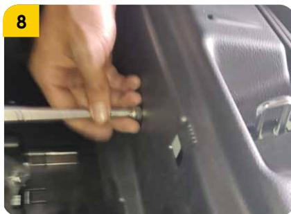
**8.** Proceder a retirar el elemento de sujeción asociado en la imagen, sería ideal realizar el desacople con una herramienta imantada para prevenir que se caiga dentro.
