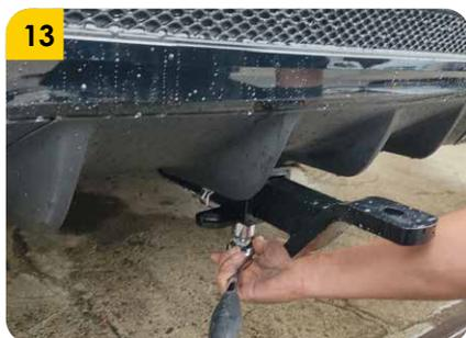
**13.** Ubicar el portabola (B), pasador (C), pin de seguridad (D) y apretar levemente el tornillo prisionero (E) para evitar vibraciones.
