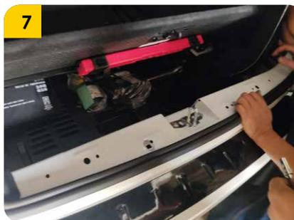
**7.** Levantar tapa inferior del porta equipaje y acceder al elemento de acople ubicado en la pared lateral asociado en el paso 8.
