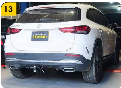
13. Ubicar el portabola (B), pasador (D) y pin de seguridad (E), proceder a apretar la bola (C) con un torque de 250ft/lb, ubicar el tornillo prisionero (F) y apretarlo para evitar vibraciones en el portabola.
