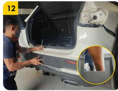
12. Ubicar el bumper plástico de forma que permita marcar el corte necesario para reinstalar el bumper plástico.
