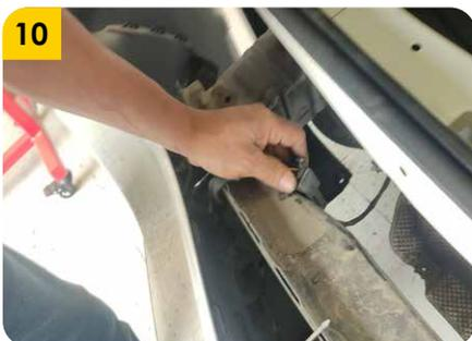
10. Realizar la desconexión del ramal de cables asociado al bumper plástico para retirarlo en su totalidad.
