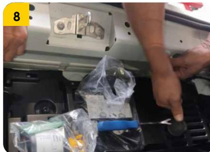
8. Retirar las tuercas de sujeción centrales del bumper plástico del vehículo.
