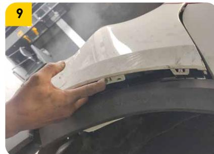
9. Despinar los acoples rápidos del bumper a cada lado del vehículo y retirar los elementos de sujeción inferiores del bumper para así y desacoplarlo.
