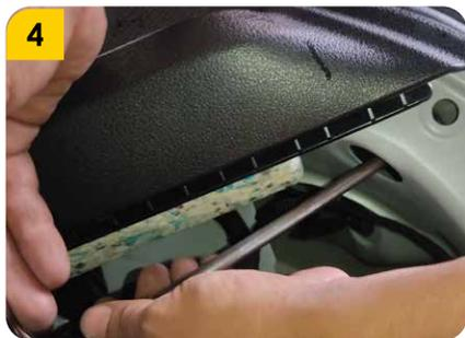
4. Mover la alfombra de la maleta de forma tal que se permita retirar las tuercas de sujeción de las luces traseras del vehículo.
