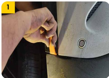
1. Retirar los bisels plasticos de ambos guardabarros con la precaución de evitar que un acople rapido se dañe.
