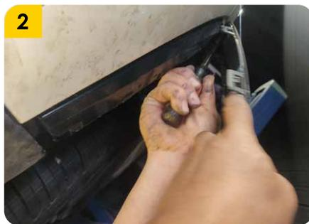
2. Retirar el pin de acople con la ayuda de un destornillador.
