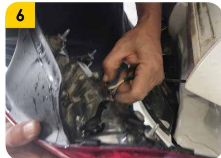
6. Realizar la desconexión del ramal de cables de cada luz trasera.
