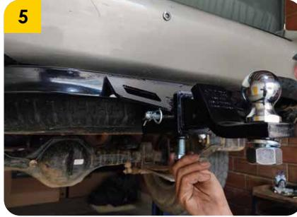
3. Ubicar el pasador (D), pin de seguridad (E) y el tornillo prisionero (F), apretarlo de tal forma que evite vibraciones en el porta bola.
