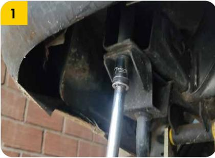
1. Desacoplar el gancho trasero del lado del conductor.
