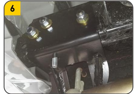
6. Colocar el tornillo (I) dentro de la platina (J) e introducir ambos dentro del chasis, para luego sacar la punta del tornillo, por la perforación inferior del chasis y el tiro de arrastre. Repetir al otro lado del chasis.
