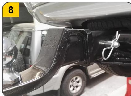
8. Colocar el Porta bola y asegurar con pasador y pin, por ultimo apretar firmemente la bola.
