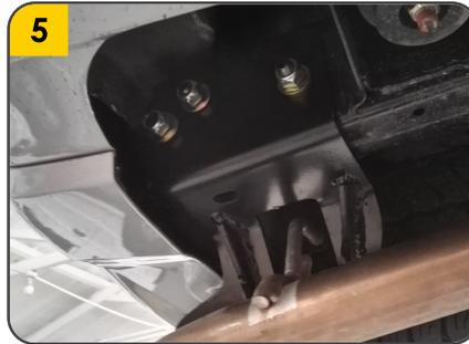
5. Situar las platinas con tornillos en el chasis y tiro de arrastre y asegurar firmemente con las tuercas (G) y arandelas (H).
