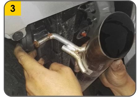
3. Desenganchar el exosto del soporte de caucho.
