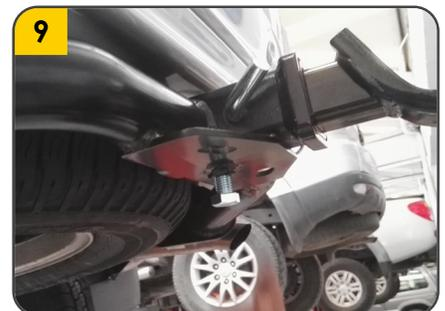
9. Para evitar vibraciones en el Porta bola fijar el tornillo (E) a la tuerca ubicada en la parte inferior del tiro de arrastre.
