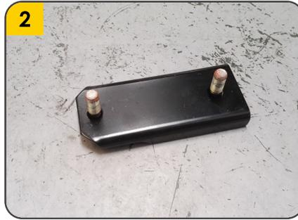
2. Retirar la platina con tornillos que sujetaba el gancho derecho, y reemplazarla por la platina (F). La platina izquierda no se retira.
