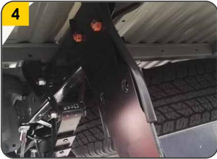
4. Utilizar la platina con tornillos que originalmente sostienen la platinas en **S** para fijar dichas platinas y el Tiro de arrastre al chasis, fijar con los tornillos **(I)** y arandelas **(J)**
