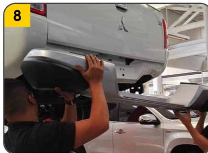
8. Para evitar vibraciones en el Porta bola fijar el tornillo **(E)** a la tuerca ubicada en la parte inferior del tiro de arrastre.
