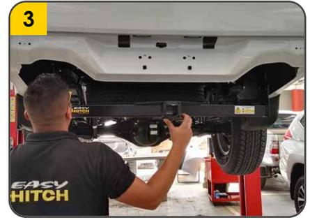
3. Utilizando la 2 platina del paso anterior, acoplar los extremos del tiro de arrastre dentro de ellas y luego acoplar al chasis.
