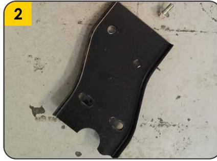
2. Soltar las 2 Platinas en **S** que unían el Bumper con el chasis del vehículo.
