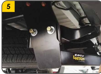
5. Acoplar el bumper nuevamente en las platinas en **S** y sujetar usando los tornillos **(F)**, arandelas **(G)** y wasas **(H)**.
