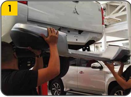
1. Retirar el Bumper trasero del vehículo soltando los 4 tornillos que lo unen a unas platinas en **S**.
