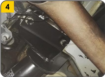
4. Utilizando los (4) tornillos y (4) arandelas retiradas en el paso 1, asegurar el tiro de arrastre a la parte inferior del chasis.
