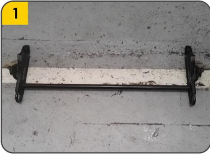
1. Retirar la barra de arrastre ubicado en el chasis, los tornillos de la barra serán utilizados para instalar el tiro de arrastre.
