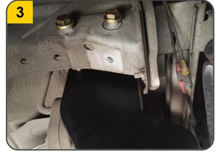
3. Fijar inicialmente los extremos del tiro de arrastre al chasis utilizando los tornillos pasantes (F), las arandelas (G) y wasa (H).
