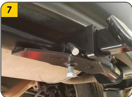
7. Para evitar vibraciones en el Porta bola fijar el tornillo (E) a la tuerca ubicada en la parte inferior del tiro de arrastre.
