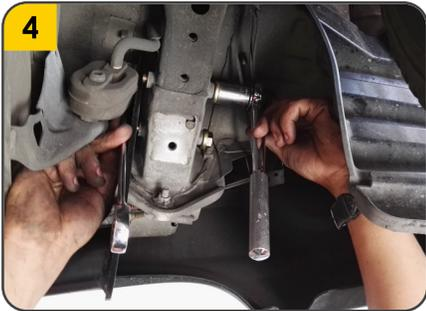
4. Por ultimo apretar firmemente el tiro de arrastre con las tuercas (I). Para que el tornillo no gire mientras se aprieta, este debe sujetarse con una llave.
