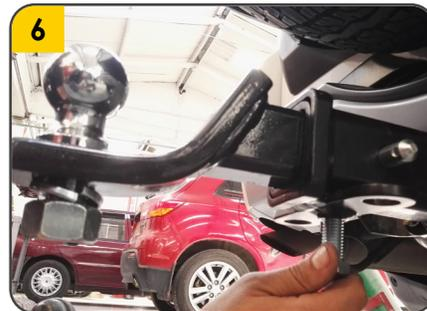
6. Para evitar vibraciones en el Porta bola fijar el tornillo (E) a la tuerca ubicada en la parte inferior del tiro de arrastre.
