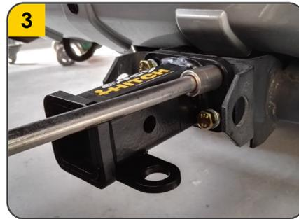
3. Sujetar el Recibidor Macho y la platina en U con los 4 tornillos (F) y las 4 Wasas (G)
