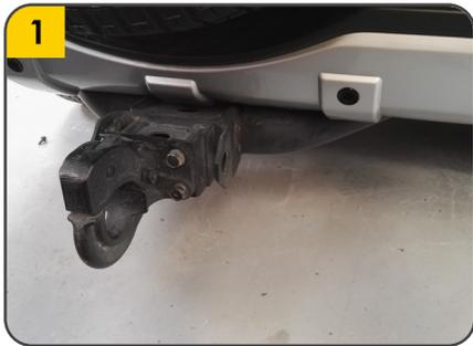
1. Retirar el pico de loro y todos sus componentes los cuales vienen por defecto instalados en el tiro de arrastre del vehículo.
