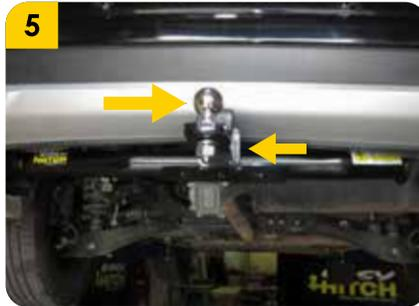
5. Colocar el Porta bola (**B**), asegurar con pasador (**C**) y pin de seguridad (**D**), y apretar firmemente la bola.
