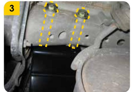
3. Colocar los tornillos (**F**) a ambos lados sin apretar, con sus respectivas arandelas (**G**) y tuercas (**H**), para unir el **tiro de arrastre** con el **chasis**.
