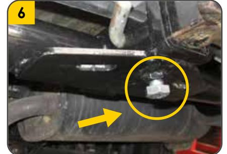
6. Para evitar vibraciones en el Porta bola (**B**) fijar el tornillo (**prisionero E**) a la tuerca ubicada en la parte inferior del tiro de arrastre.
