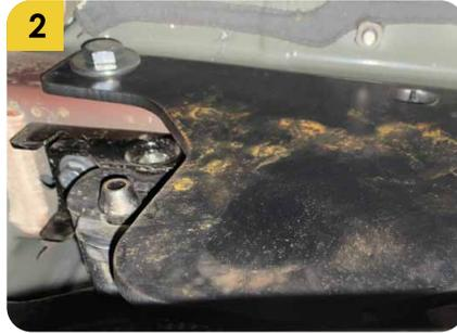
2. Acoplar el tiro de arrastre a la carrocería del vehículo. Posicionar un tornillo (G) y arandela (H) a cada lado del tiro de arrastre y posteriormente colocar el resto de tornillos para procedera aplicar un torque de 86 ft/lb.
