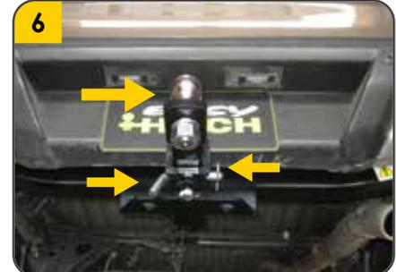
6. Colocar el Porta bola **(B)**, asegurar con pasador **(C)** y pin de seguridad **(D)**, y apretar firmemente la bola.
