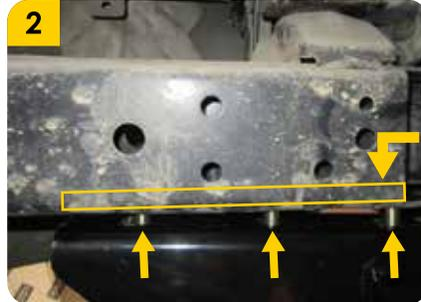
2. Insertar la **platina de anclaje (F)** al lado contrario de donde se retiro el **gancho**. Debido a que las perforaciones de ese lado no tienen rosca para los tornillos.
