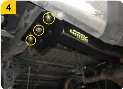
4. Colocar los tornillos **(I)** a ambos lados sin apretar, con sus respectivas arandelas **(G)** y guasas **(H)**, para unir el **tiro de arrastre** con el **chasis**.
