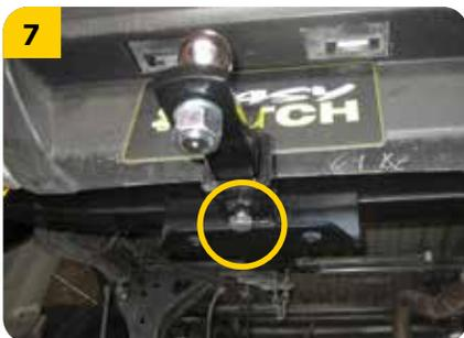
7. Para evitar vibraciones en el Porta bola **(B)** fijar el tornillo **(prisionero E)** a la tuerca ubicada en la parte inferior del tiro de arrastre.
