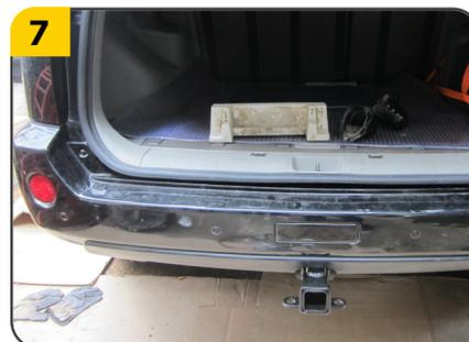
7. Colocar nuevamente el **bumper** y apretar firmemente todos los **tornillos del bumper** y los tornillos (**F**) del  **tiro de arrastre**.
