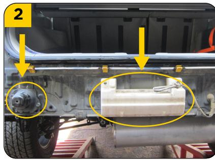
2. **Remover** del vehículo las piezas señaladas (**tope del bumper y pieza en icopor**)
