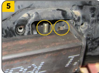
5. Colocar los tornillo (**F**) con sus respectivas guías (**G**) y arandelas (**H**) sin apretar, para unir el  **tiro de arrastre** con el **chasis**.
