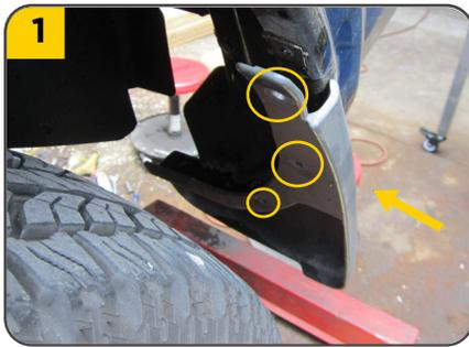
1. Bajar el **bumper** del vehículo, removiendo todos los **tornillos** de ensamblaje.
