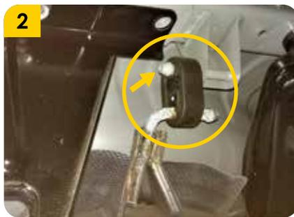
2. Bajar el **exosto** retirando el **enganche** para una mayor comodidad y facilidad en la instalación del **tiro de arrastre**.
