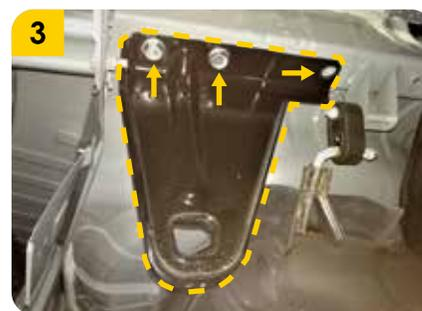
3. Retirar el **gancho** del **chasis** señalado en la imagen (de esas perforaciones se va a anclar el **tiro de arrastre**).
