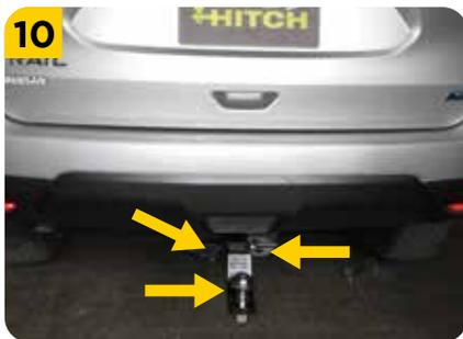
10. Colocar el Porta bola **(B)**, asegurar con pasador **(C)** y pin de seguridad **(D)**, y apretar firmemente la bola.
