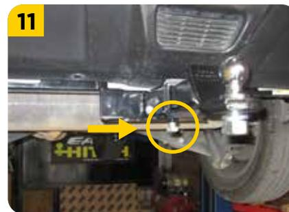
11. Para evitar vibraciones en el Porta bola **(B)** fijar el tornillo **(prisionero E)** a la tuerca ubicada en la parte inferior del tiro de arrastre.
