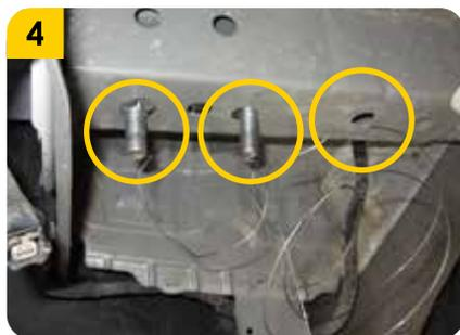
4. Ubicar cada una de las perforaciones de anclaje, y utilizando la técnica de **pesca**, colocar los **tornillos de carriaje (F)** dentro del **chasis** con sus respectivas **platinas (I)** y **pescas (H)**.
