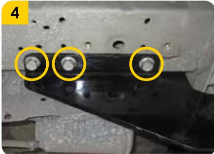
4. Colocar los **10 tornillos (F)** con sus respectivas **arandelas (G)** y **tuercas (H)**.
