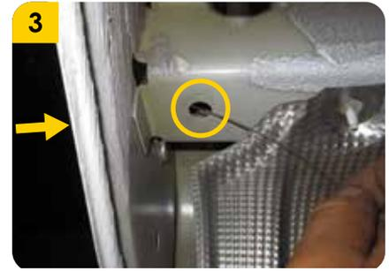
**3.** Realizar la técnica de **pesca**, colocar los **tornillos de carruaje (F)** dentro del **chasis** con sus respectivas **platinas (G)** y **pescas (H)**.
