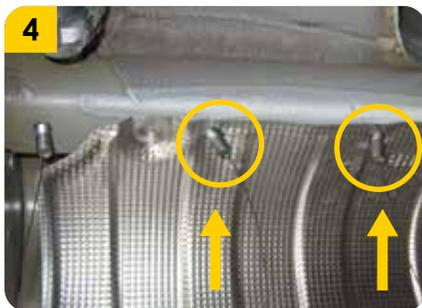
**4.** Romper el **aislante de calor** en las perforaciones ubicadas en el **chasis** por donde van a salir los **tornillos (F)**.
